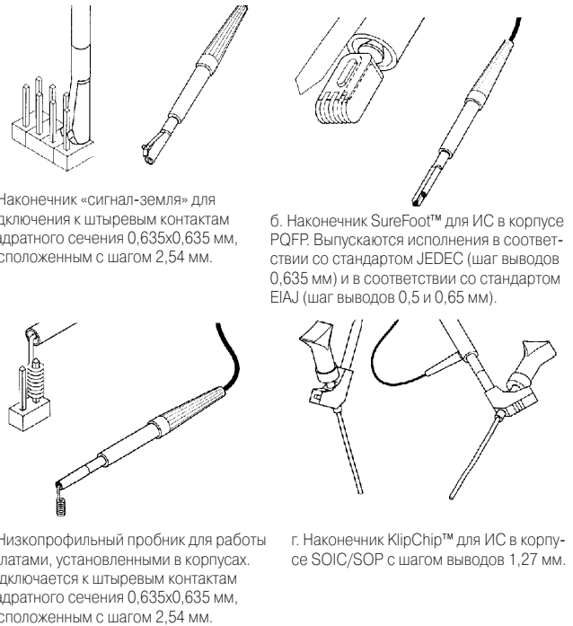
Рис. 2.16. Примеры наконечников для малогабаритных пробников. Некоторые наконечники значительно упрощают подключение к миниатюрным контактам и могут повышать точность измерения, предлагая высокоинтегрированное решение для подключения к контрольным точкам.
